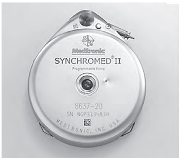
図3：薬液ポンプの外形(87.5×19.5mm) 中心部がシリコン製になっており専用のキットで経皮的に穿刺し薬液を補充する。
