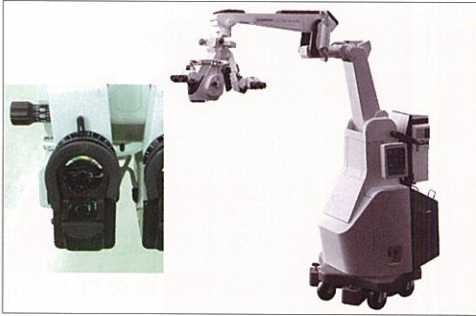
図1 手術用顕微鏡OLYMPUS社製OME 9000、及び術者接眼部の拡大接眼レンズ下に蛍光撮影用レンズが設置されており、術者は下方へ視野を移すことで、内蔵蛍光フィルターを介した画像を同時観察することが可能である。
